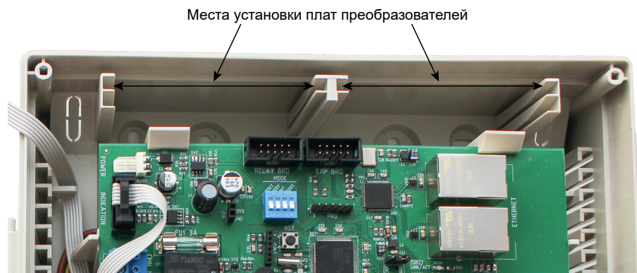
Рисунок 2. Места установки плат преобразователей OMP-W02 в корпусе контроллера Parsec
